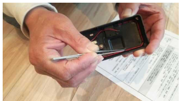
写真2：折り紙用ピンセットにより、配線をリムに埋め込む作業
