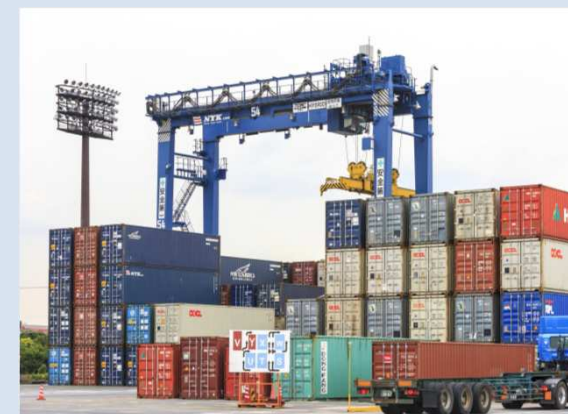
トランスファークレーンの外観
