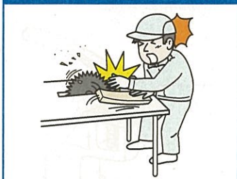
丸のこ盤で木材板を切断中 指を切断しそうになった
