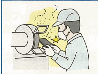
高速回転砥石切断機による 鉛ヒュームで慢性鉛中毒
