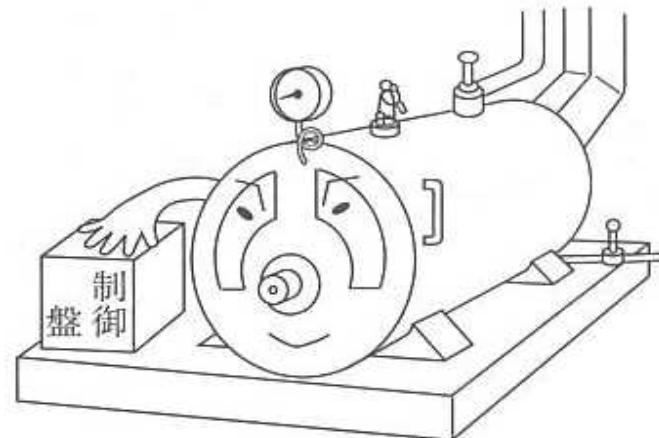
信頼性の確認できない制御装置(自動停止機能等)を装備したボイラーの資格者による点検(1日に1回以上)
