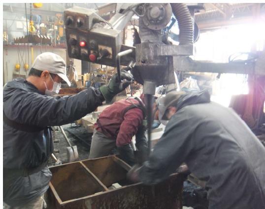
図 2.3 手込め作業風景
