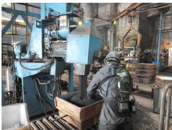
図 2.5 手込め作業風景
