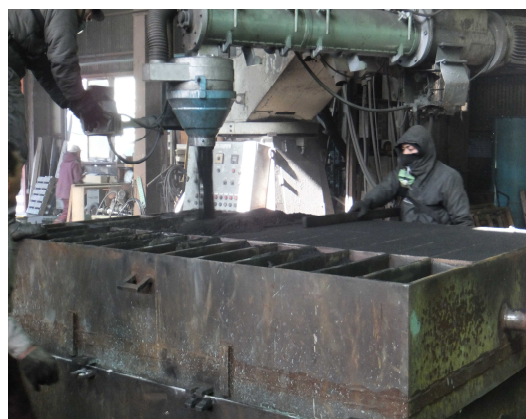
図 2.4 手込め作業風景
