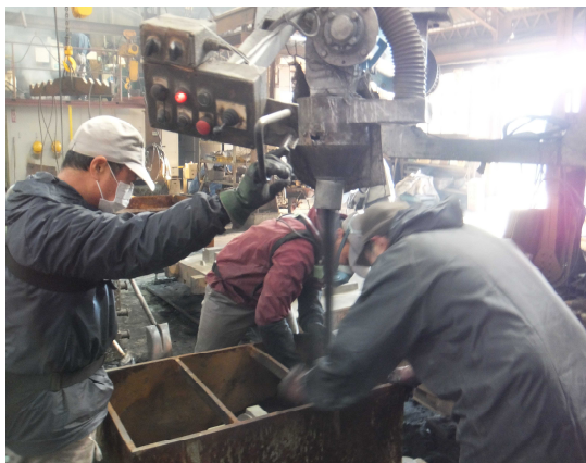
図 2.3 手込め作業風景
