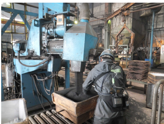
図 2.5 手込め作業風景
