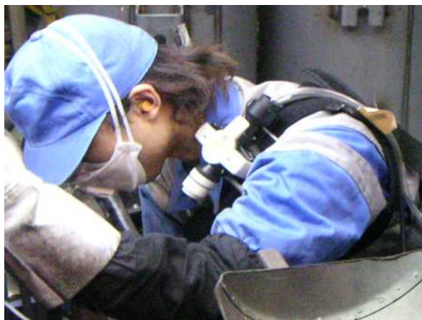
図 2.1 LD-6N デジタル粉じん計の装着状況
