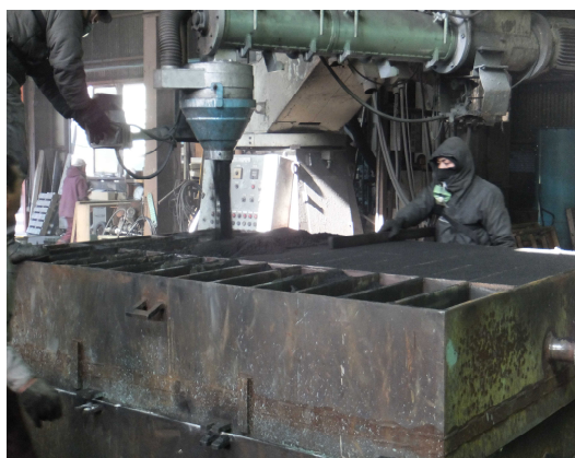
図 2.4 手込め作業風景
