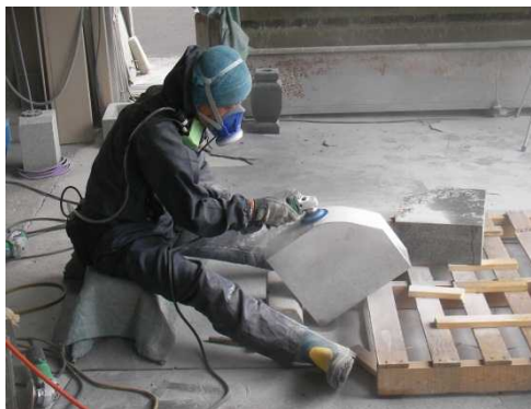
図 2.1 石材に対する研ま・ばり取り作業の様子
