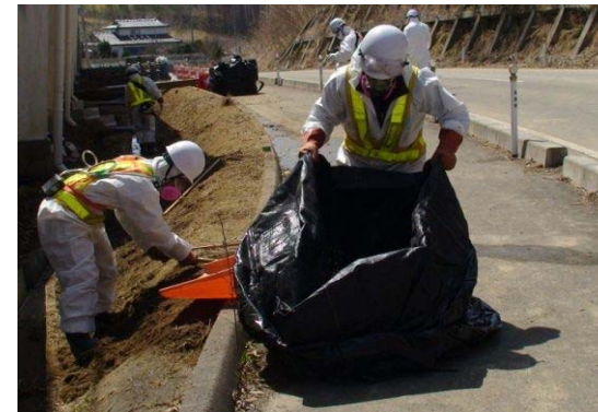
現場調査(福島県内) 作業者に粉じん計を付けていただき測定中
