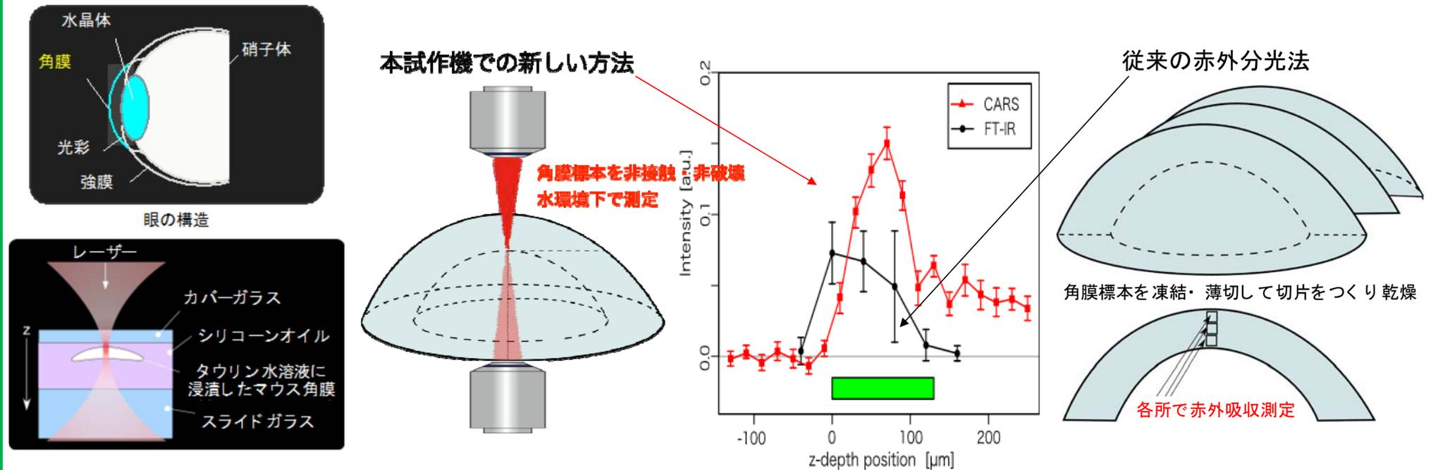
従来可視化が困難であった、生体中の低分子化合物の局在分布と動態を、その場で分子構造を同定しながら画像化する「位相制御コヒーレントラマン顕微鏡」
