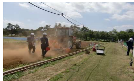
模擬実験 機械を用いた土壌掻き取り作業(爪を回転させて土の表面を砕いている)
