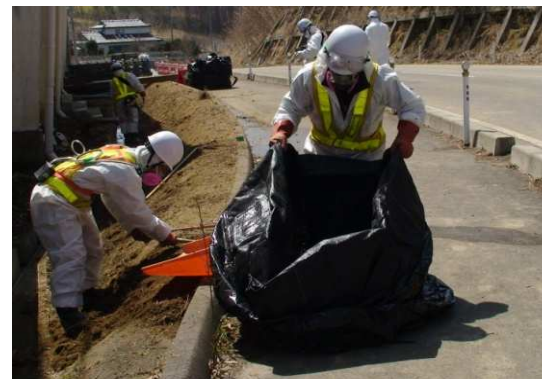
現場調査(福島県内) 作業者に粉じん計を付けていただき測定中
