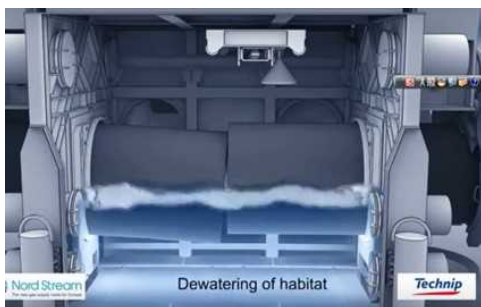
ドライチャンバー内排水状況(Technip)
