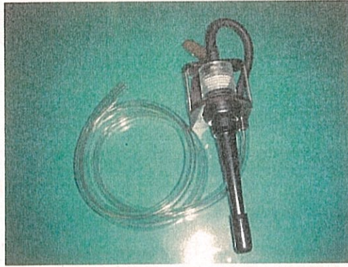
写真3 サイクロン方式分粒装置 (GS-3) とフィルターホルダーの概観
