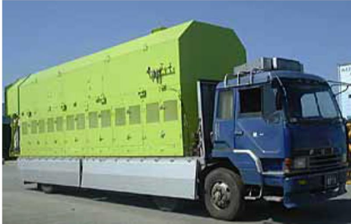
1998年 三井三池 フィルター式集塵機 2000m 3 /min
