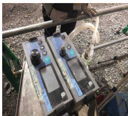
図 3.8 デジタル粉じん計の測定終了後の状況図
