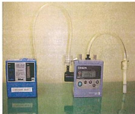
分粒装置と相対濃度計を組合せたサンプリング装置例
