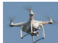
UAV(ドローン等)による3次元測量
