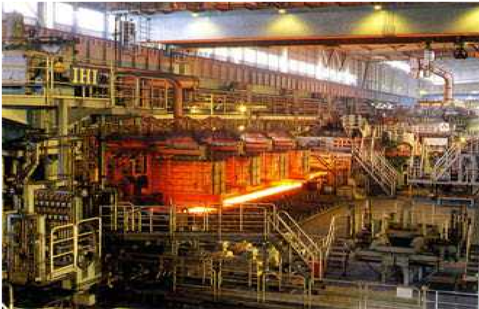
鉄鋼 圧延加熱炉
