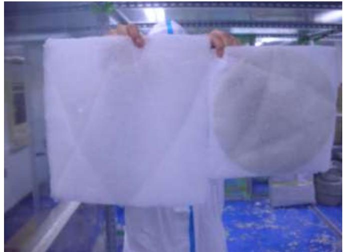
写真2 新品(左)と目詰り(右)したフィルター
