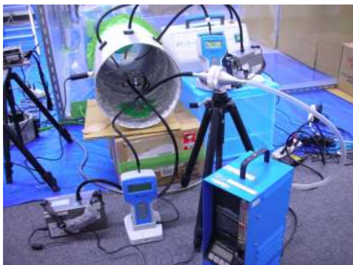
写真1 排気口の測定機材の設置状況
