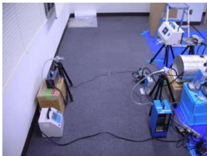
写真2 排気口の測定機材の設置状況
