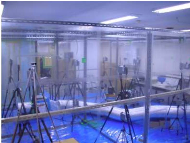
作業室の概要（粉じん計の配置状況）
