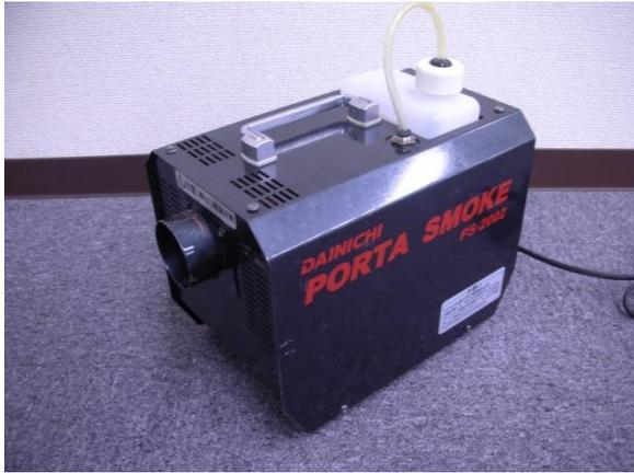
写真6 舞台演目の煙の発生装置の概要
