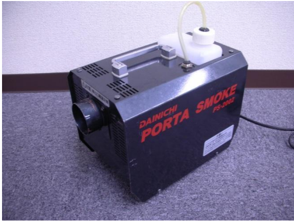
写真6 舞台演目の煙の発生装置の概要
