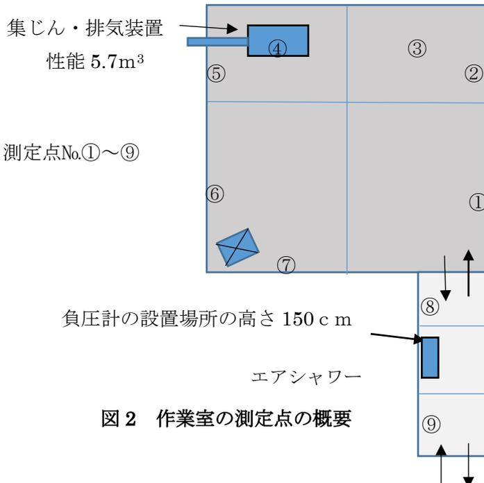
図2 作業室の測定点の概要
