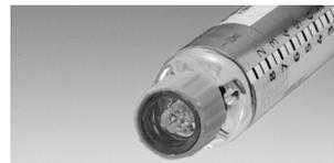
〈シリンジの注入口先端が欠ける〉
