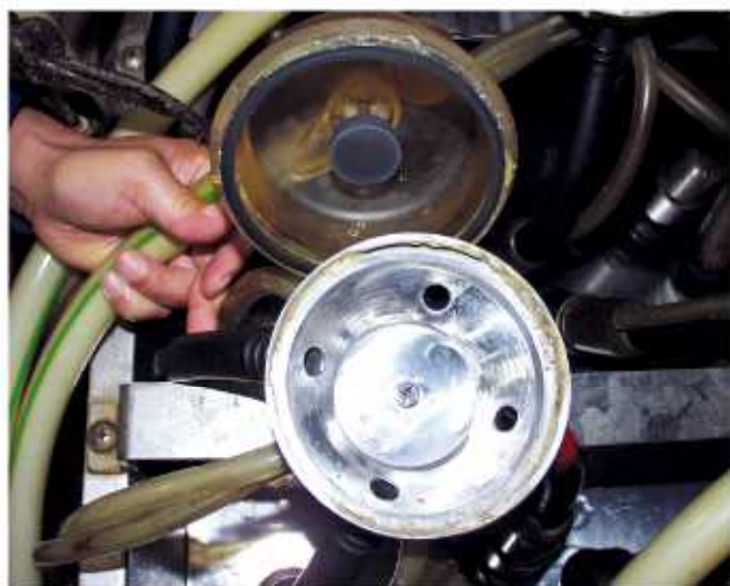
写真3. クロー内部の汚れ
