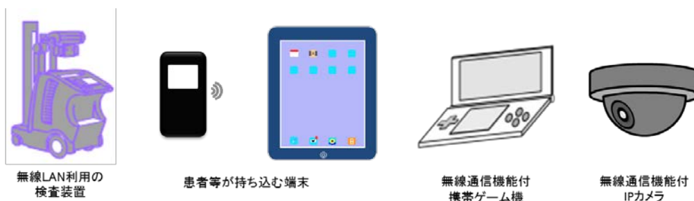
図 25 持ち込み端末や管理外の AP 等による電波干渉
