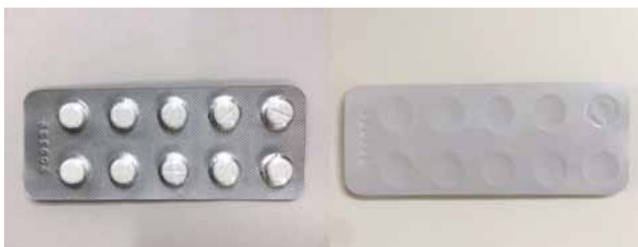
写真 1 製作した試験用 P T P の外形
