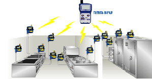
低温室等の自動温度記録器・警報機 (温度管理等の自動化による確実性向上)
