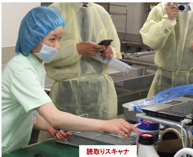
手術器材の二次元バーコードを読み取り、組立て明細と瞬時に照合
