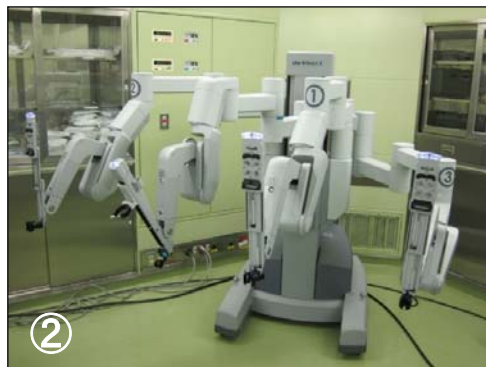
② 器具を取り付けて患者さんの①で操作する手術者の動作を伝え、お腹の中で操作するロボット本体
