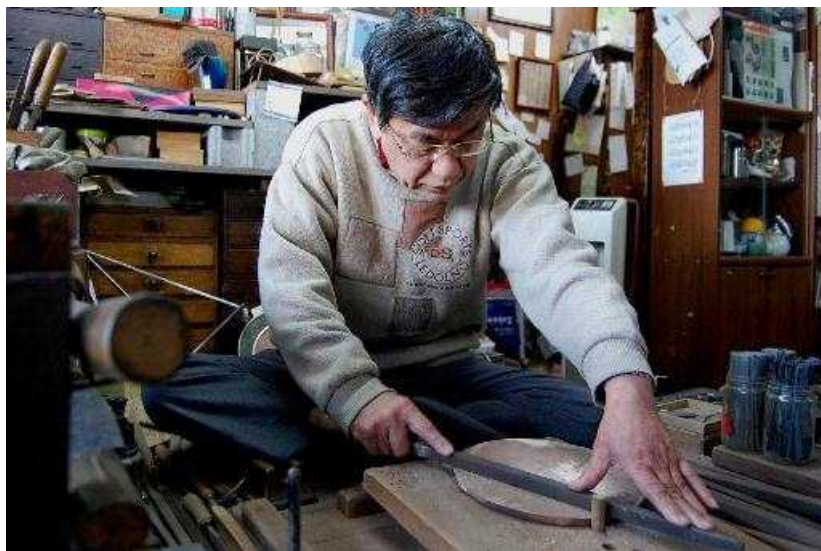
鑿（やすり）切削・鏡の表面をやすりで研磨する工程。 全て手作業で一切の機械を用いない。
