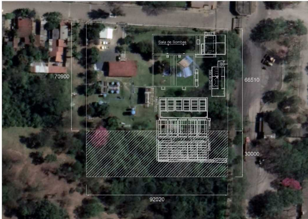
Figura 3.3.6 Análisis de uso de espacio abierto de la planta de tratamiento de Villa Hayes (en caso de alternativa 1)
