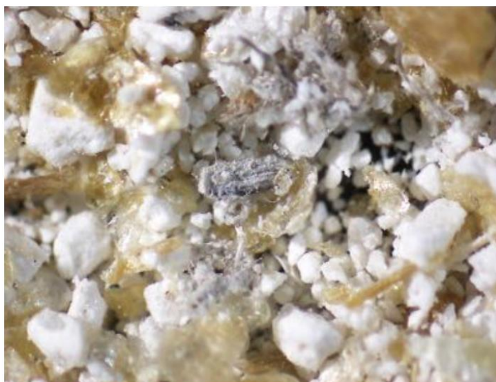
図 3.54 沈降した成分中のアスベスト繊維（中央の繊維束）
