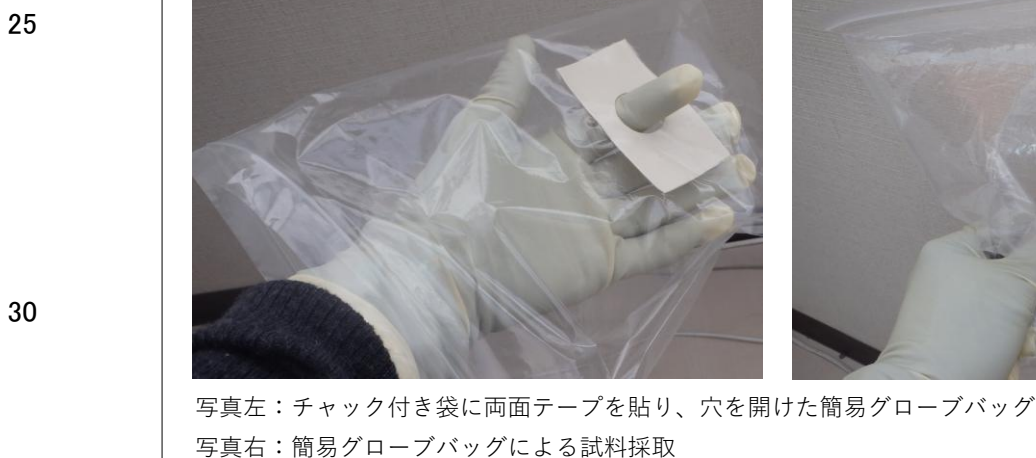
図 3.23 簡易グローブバッグによる試料採取の例
