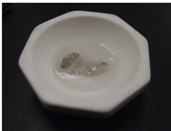
図 3.49 試料をメノウ乳鉢に入れて塩酸を加え、乳棒で崩す
