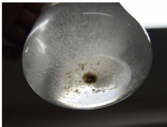
図 3.50 回転させるように攪拌すると底部に骨材のような重い成分が集まる
