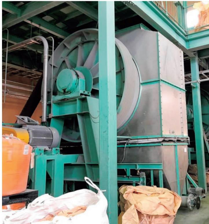
写真2. 粉砕機（ミル）：シリカ原石を粉砕機の中に入れ、数日間回転することで、中のシリカが粉砕され、数ミクロンの微粒子になる。
