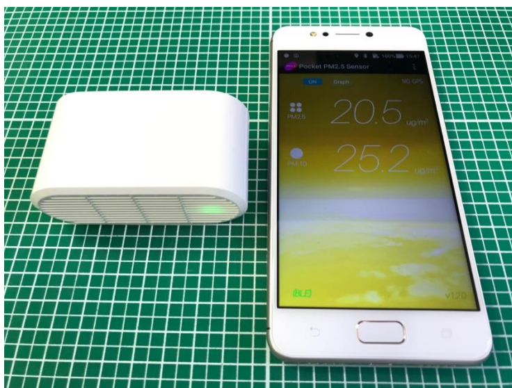
図 4. Bluetooth 無線方式でスマホと連結されたポケット PM2.5 センサー。約 2.5～3.0 時間の連続測定が実現された。PM2.5/10 値 ( 0\sim999\mu\text{g}/\text{m}^3 )、GPS 情報、時刻を csv 形式で書き出すことができる。
