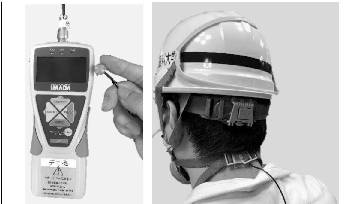
図4. 締め圧測定機器と締め圧測定風景 左の写真が測定機器で、大きい機器がアンプ部分、手で持っている部分が、ロードセル部分である。右の写真が測定風景。呼吸用保護具の下側の締めひもと頸部の間にロードセルを挟んで測定を実施した。
