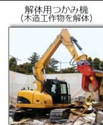
解体用つかみ機 (木造工作物を解体) キャタピラージャパン株式会社製 同社提供
