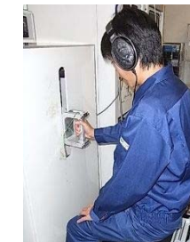
騒音/手腕振動複合ばく露実験
