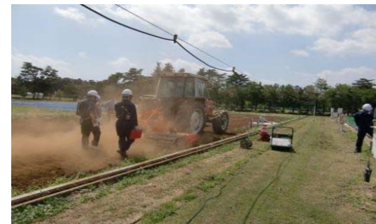
模擬実験 機械を用いた土壌掻き取り作業(爪を回転させて土の表面を砕いている)
