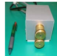
図2 双極性防爆構造除電器
