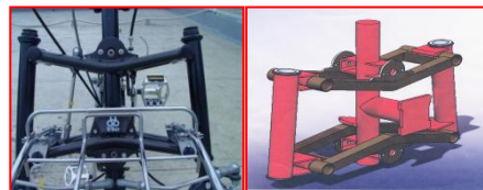
〈3次元CADを用いたモデリング（平行リンク）〉
