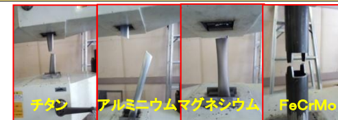
〈代替材料候補における強度試験（引張）〉
