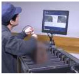
ファイバースコープによる鋳物製品内部の検査作業
