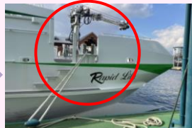
自動遠隔係船装置(旋回アーム)
