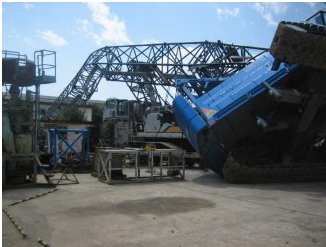
[千葉県で発生したクレーン転倒災害の災害調査]
