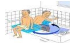
・ロボット技術を用いて浴槽に出入りする際の一連の動作を支援する機器
