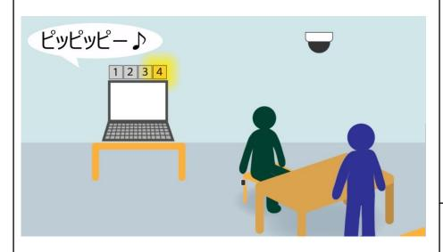
カメラでの利用者の頭の動きと、椅子の動き (加速度センサー)が設定した範囲を超え ると、メインの P C に警告を知らせる。メイン のパソコンには映像とともに警告が表示され、 さらに外部の警告灯が点灯するシステム。
