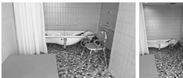
▲シャワー室の中に浴槽を常設し、シャワー栓にホースを接続して直接給湯
