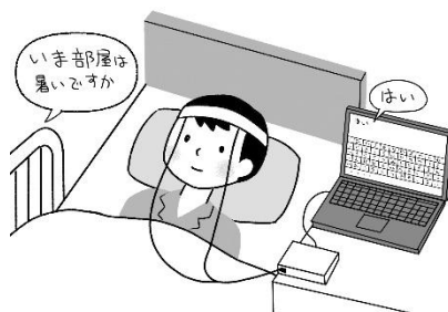
図5 生体現象方式の意思伝達装置
