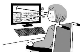
図14 視線検出式入力装置
