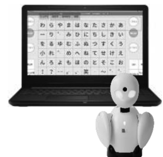
図 1 重度障害者用意思伝達装置「OriHime eye + Switch」と分身ロボット「OriHime」
