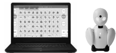
図1 重度障害者用意思伝達装置「OriHime eye+Switch」と分身ロボット「OriHime」
