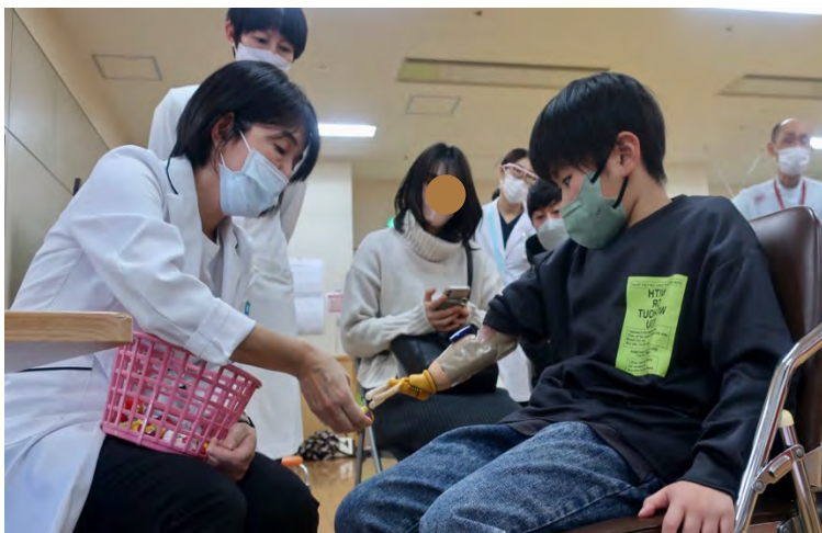
仮組みの筋電義手を用いた操作確認
