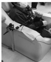
クッションチェアに固定具設置 ・入力装置：ジョイスティックマウス ・入力動作：テンココントロール
