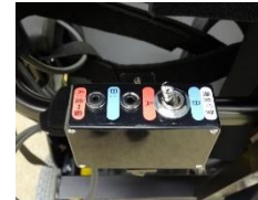
頭部スイッチの電動車椅 子／PC 操作切替装置
