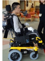
頭部スイッチは、電動車椅子のモード切替 (走行⇄姿勢変換)用のスイッチと併用
