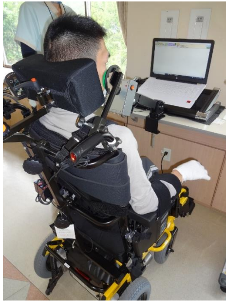
電動車椅子で近づき、PC を操作できるように、 PC と顎での入力装置(らくらくマウス)を設置
