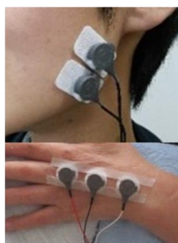
図 25 身体機能の変化に応じた入力装置等⑦（筋電式入力）
