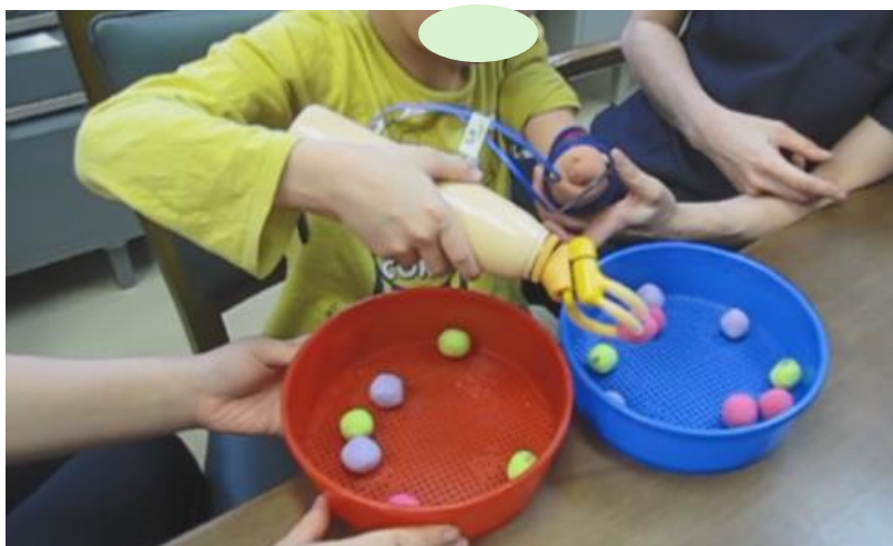
筋電信号の導出と操作練習の様子
