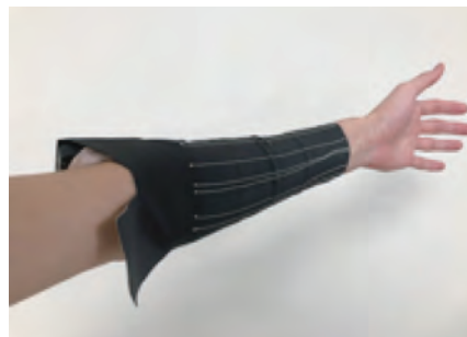
図2.サポーター型筋電計測機
